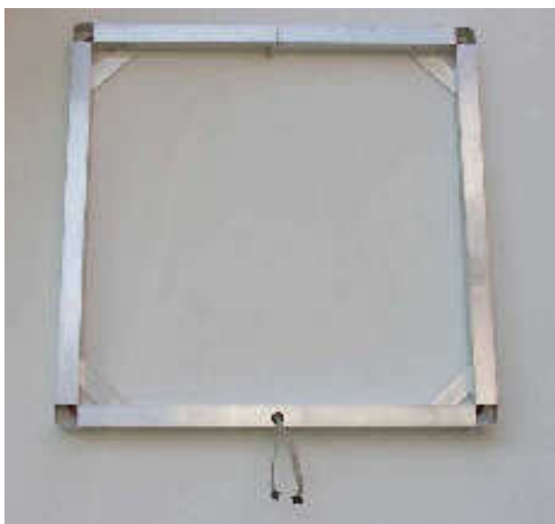
Fig. 18 Prototipo di antenna per il sistema Prediktor realizzata da IV3ALA e IV3NQS
